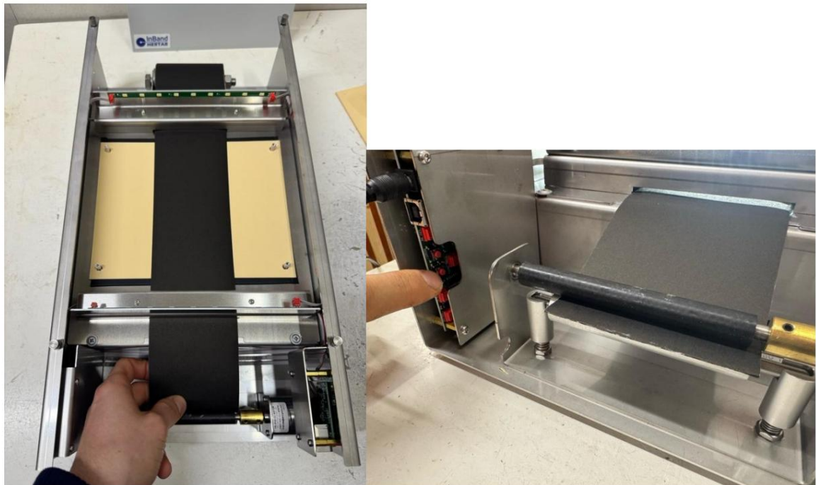
Kuva 4. Pohjapaperimaskin ja mustan paperirullan asennus.
