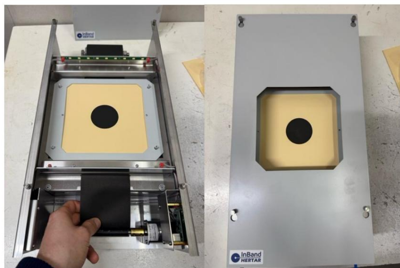
Kuva 5. Kohdesuojaimen sijoitus metallikehyksen (vasen) ja etuluukun (oikea) kanssa.
